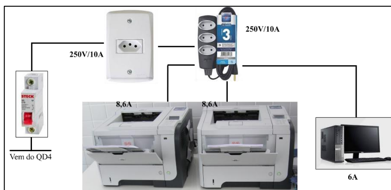
Figura 9 - Circuito terminal C05 do QD4.
